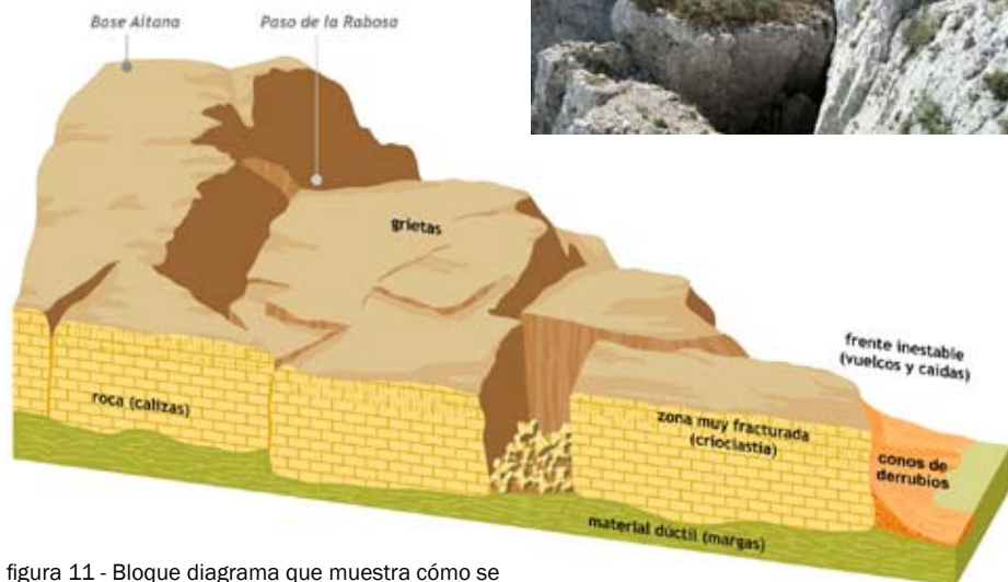
figura 11 - Bloque diagrama que muestra cómo se han formado las Simas de Partagat.
